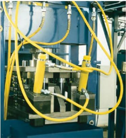
在一個特質的液壓壓床中，RR油缸提供動力和控制精度。 RR-cylinders provide power and precision in a special hydraulic press.
